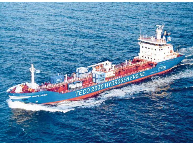
Abb. 2: Der Bitumentanker Bitflower soll das erste Schiff sein, das mit einer Brennstoffzelle von Teco 2030 fährt [Quelle: Shell]
