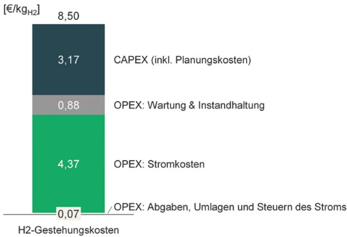
Abb. 3: Beispielhafte Wasserstoffgestehungskosten für eine Elektrolyse in Deutschland [Quelle: BBH]
