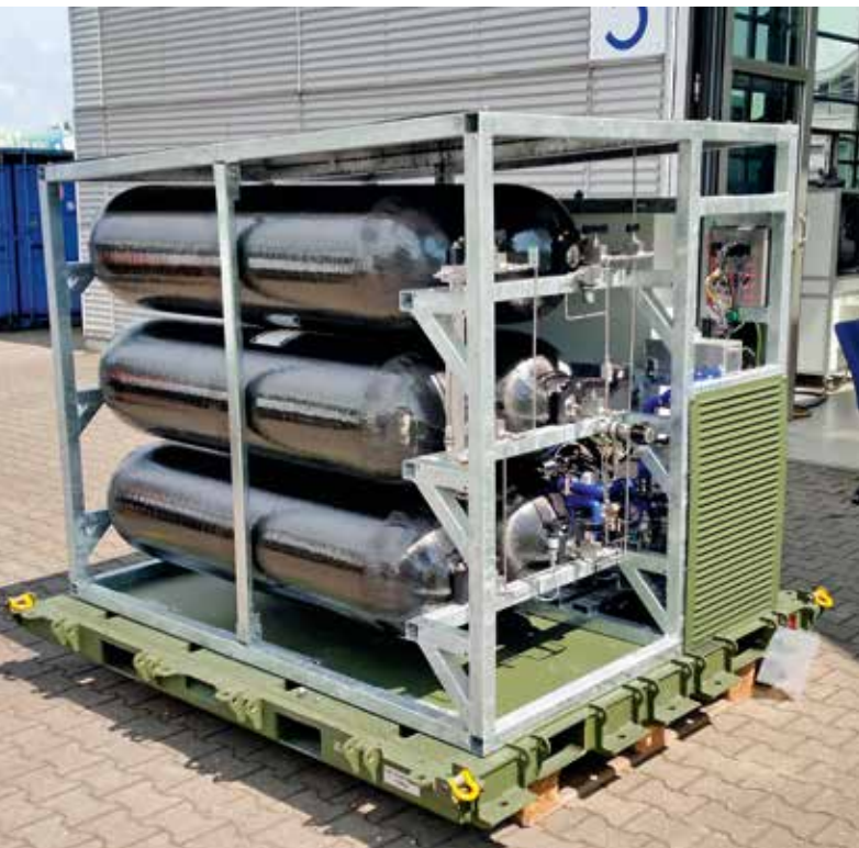
Abb. 1: Das mobile Energieversorgungssystem, aufgebaut auf der Transportpalette [Foto: Hydrogenics]
