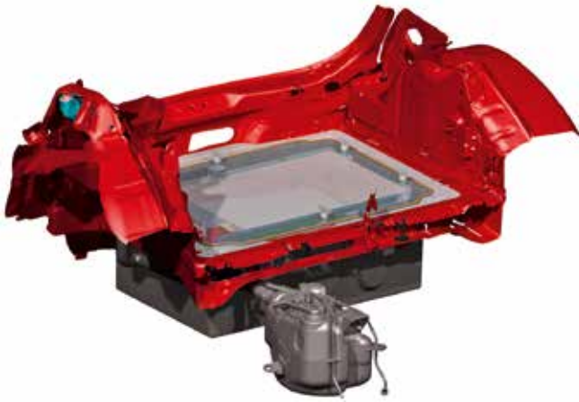
Abb. 2: CAD-Modell vom Einbau der RMFC und das Tanksystem im Heck des Audi A1 Sportsback
