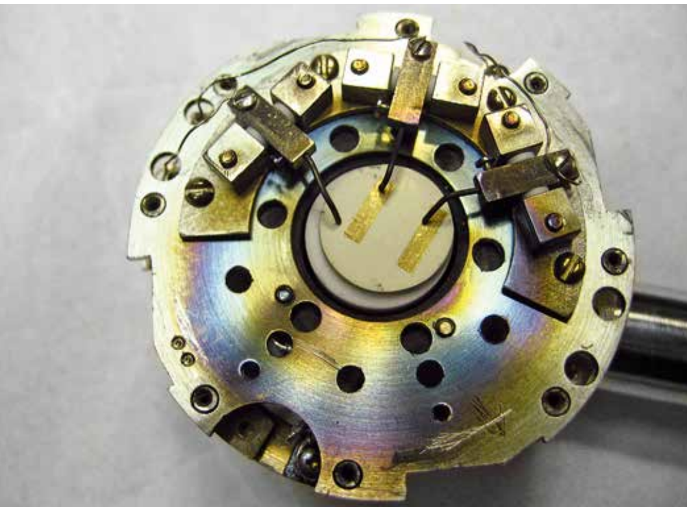
Abb. 1: Protonenleitende Elektrolytscheibe aus yttrium-substituiertem Barium-Ceroyd mit elektrischen Goldkontakten und Referenzelektrode auf einem Probenhalter für kombinierte Messungen der Impedanz und Valenzbandstruktur bei hohen Temperaturen und Feuchtigkeitskonzentrationen.
