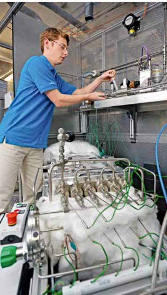
Abb. 1: Die APU, bestehend aus einer HT-PEM-Brennstoffzelle und einem H 2 -Hydrid-speicher, in der Test-Tankstelle am DLR [Foto: DLR / Frank Eppler]
