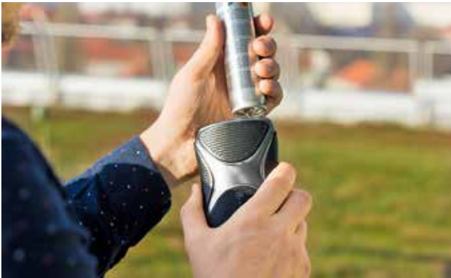
Abb. 1: „kraftwerk“ läuft mit handelsüblichem Feuerzeuggas. [Quelle: eZelleron]
