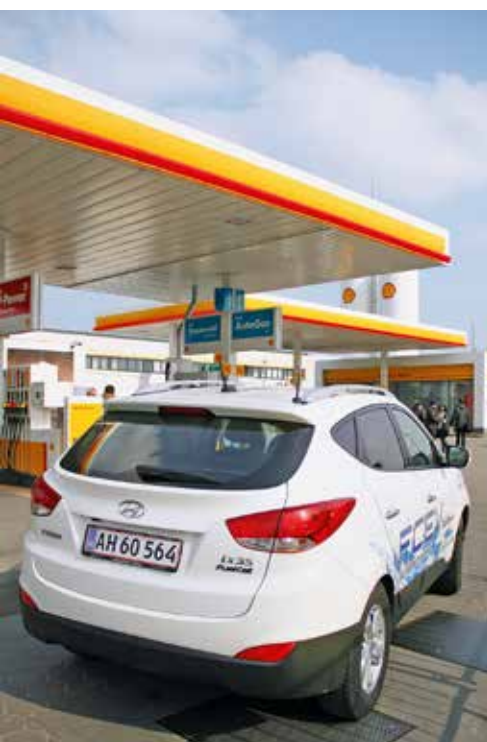
Abb. 1: Neuer Hyundai ix35 Fuel Cell an neuer H 2 -Station – hinten die beiden neuen Hochtanks
