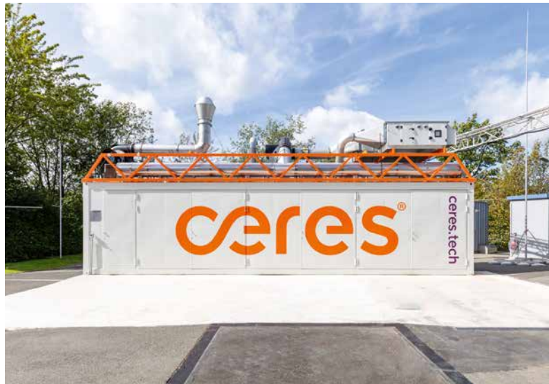
Abb. 4: 1-MW- Festoxid-Elektrolyseur von Ceres Power [Quelle: Ceres Power]
