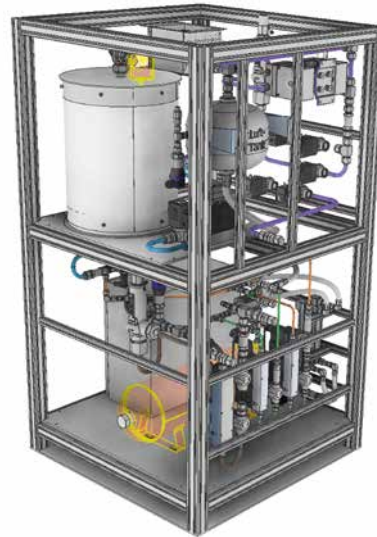
Abb. 20: Ammoniak-Cracker-Anlage zum Einsatz auf einer Segeljacht [Grafik: ZBT]
