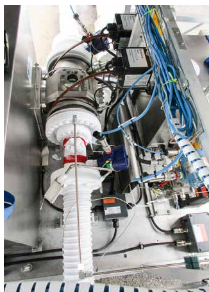
Abb. 3: LDV-Standard für rückführbare kryogene Durchflussmessung
