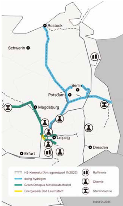
Abb. 29: Das Ontras-H 2 -Startnetz besteht aus den Projekten „Green Octopus Mitteldeutschland“ und „doing hydrogen“ [Grafik: Ontras]
