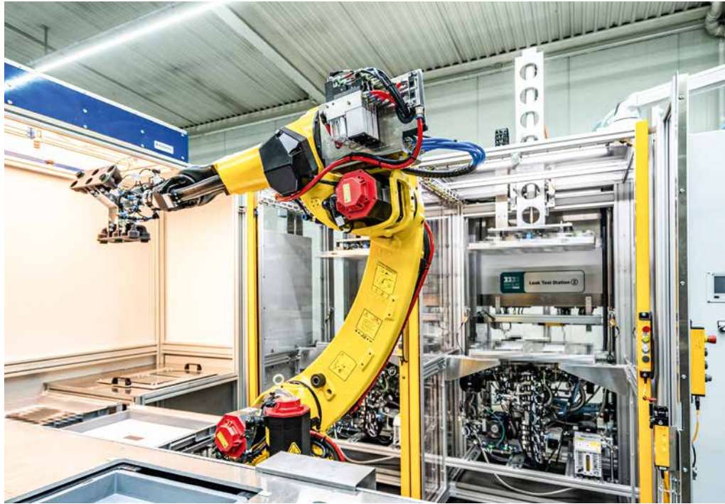
Abb. 26: Neue Anlage von Maceas zur Dichtheitsprüfung von Bipolarplatten [Foto: Maceas GmbH]
