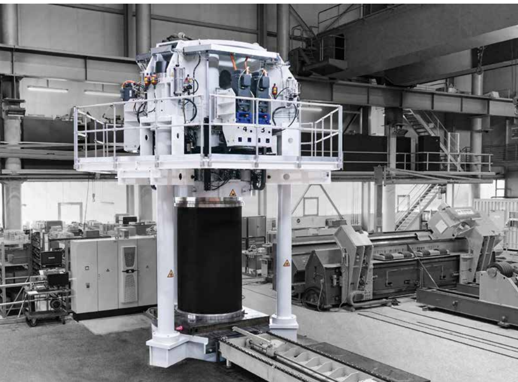
Abb. 23: Die neue Stack-Press für Elektrolyseure [Foto: Graebener Maschinenteknik ]
