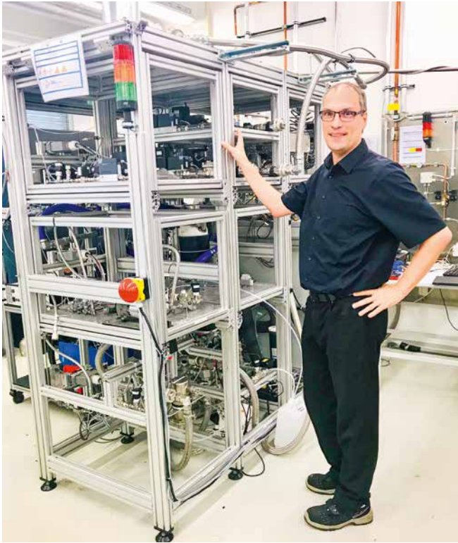
Abb. 3: Sebastian Altmann, Leiter des BZ-Labors (Senior Expert Fuel Cell Lab), vor einem modularen Teststand für Brennstoffzellensysteme, der am ZAL entwickelt wurde
