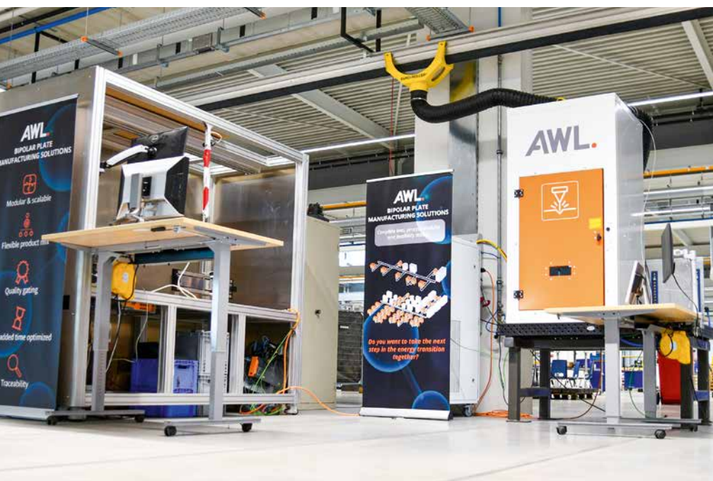
Abb. 24: Im Experience Center hat AWL eine Versuchslage aufgebaut, die auch eine automatisierte Qualitätskontrolle der Bipolarplatten ermöglicht [Foto: AWL]
