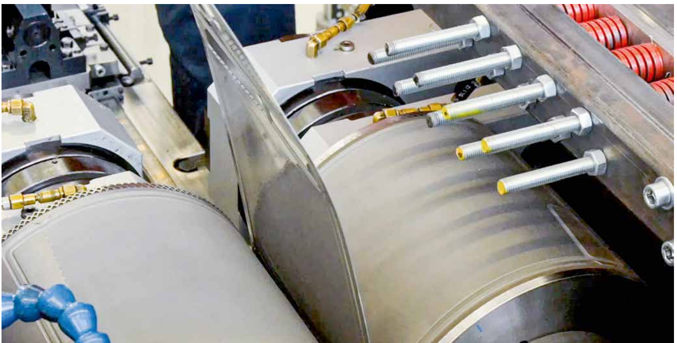
Abb. 2: Walzprägen von Bipolarplatten: Die Struktur der Bipolarplatte wird durch ein Walzenpaar geprägt. Hauptvorteil dieses Verfahrens ist die hohe Prozessgeschwindigkeit, die zu einer substantiellen Steigerung der Stückzahlproduktion, Skaleneffekten und schließlich zu einer deutlichen Reduktion der Kosten führt.
